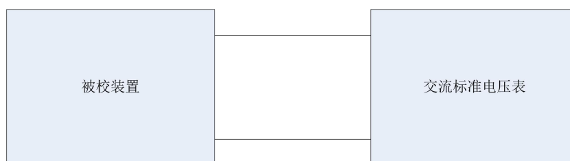
图 4 直接比较法校准交流电压示值误差示意图
