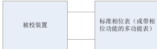
图 11 校准相位示值误差示意图
