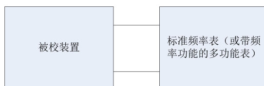
图 10 校准频率示值误差示意图
