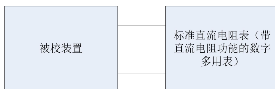
图 13 校准直流电阻示值误差示意图
