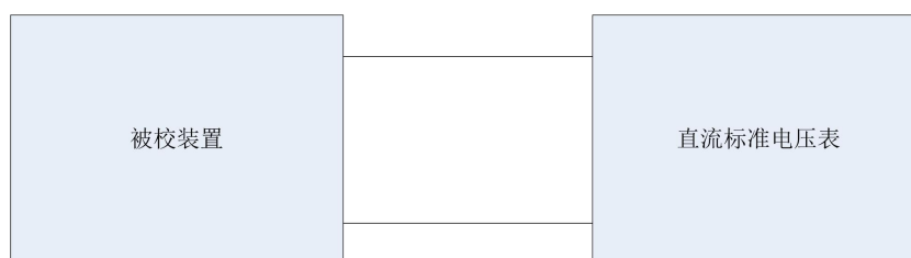
图 1 直接比较法校准直流电压示值误差示意图
